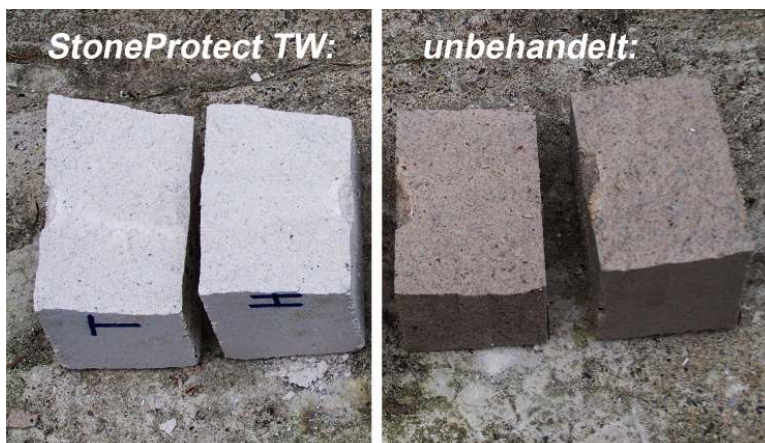
gespaltene Kalksandsteine nach 24 Stunden Unterwasserlagerung
